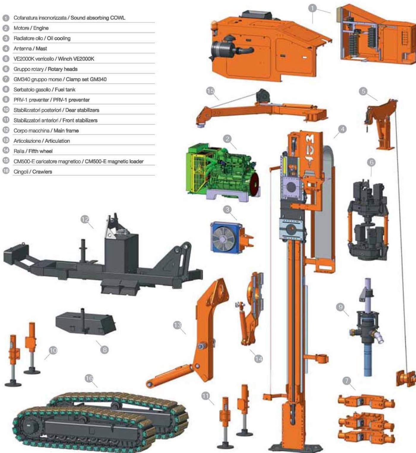
*Il motore è alloggiato nella parte posteriore della perforatrice con interposizione di supporti antivibranti.*
